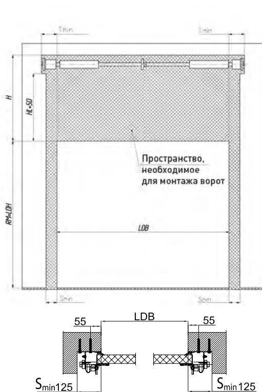
Минимальное боковое пространство (усиливающие кронштейны снаружи угловых стоек)
